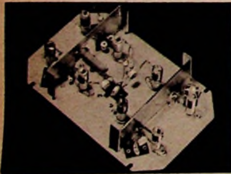
Bild 6. Antennenweiche (Gehäuse abgenommen) zum Zusammenschalten von Antennen in Band III, Band II und Band I an eine gemeinsame unsymmetrische 60- \Omega -Niederführung (Siemens Typ SAZ 761a)
