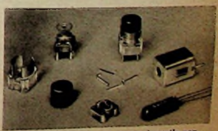
Bild 3. Die Kleinheit der Spulenteile von Vogt & Co kann man an dem zum Vergleich rechts vorn liegenden Transistor abschätzen
