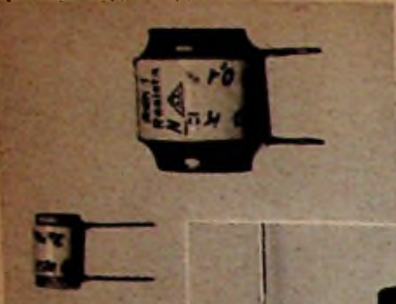
Bild 1. Hochpräzise Drahtwiderstände nach US-Vorschrift MIL-R-93
